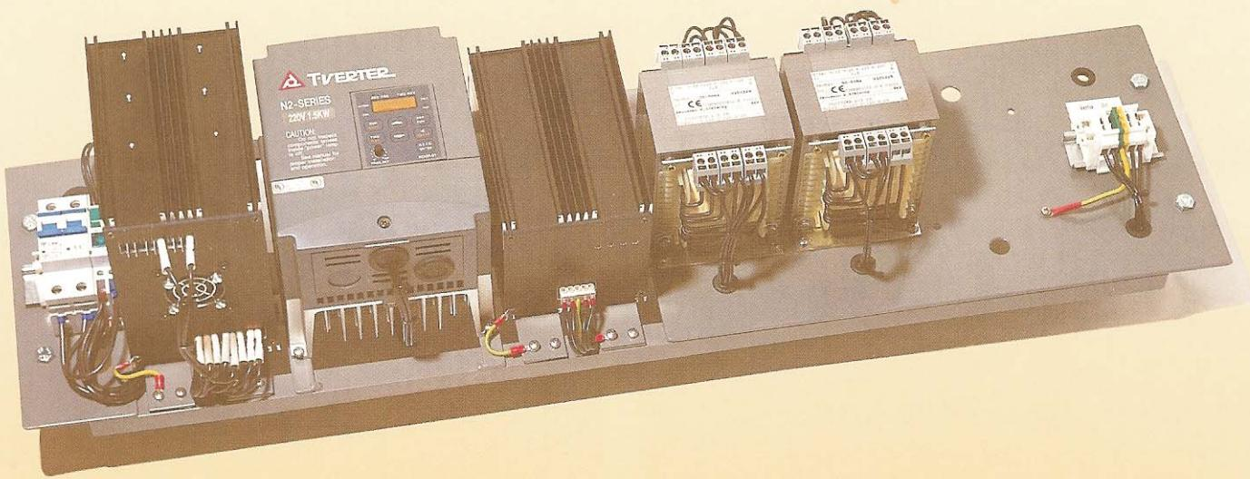
Elektronický měnič slouží k výrobě sinusového napětí 230 V, 50 Hz. Měnič je napájen ze stejnosměrného zdroje se jmenovitým napětím 24 V DC. Trvalý výstupní výkon je 500 VA. Účinnost je min. 80 %. Měnič je umístěn do rámu dvojitěho panelu universálního reléového stojanu.
