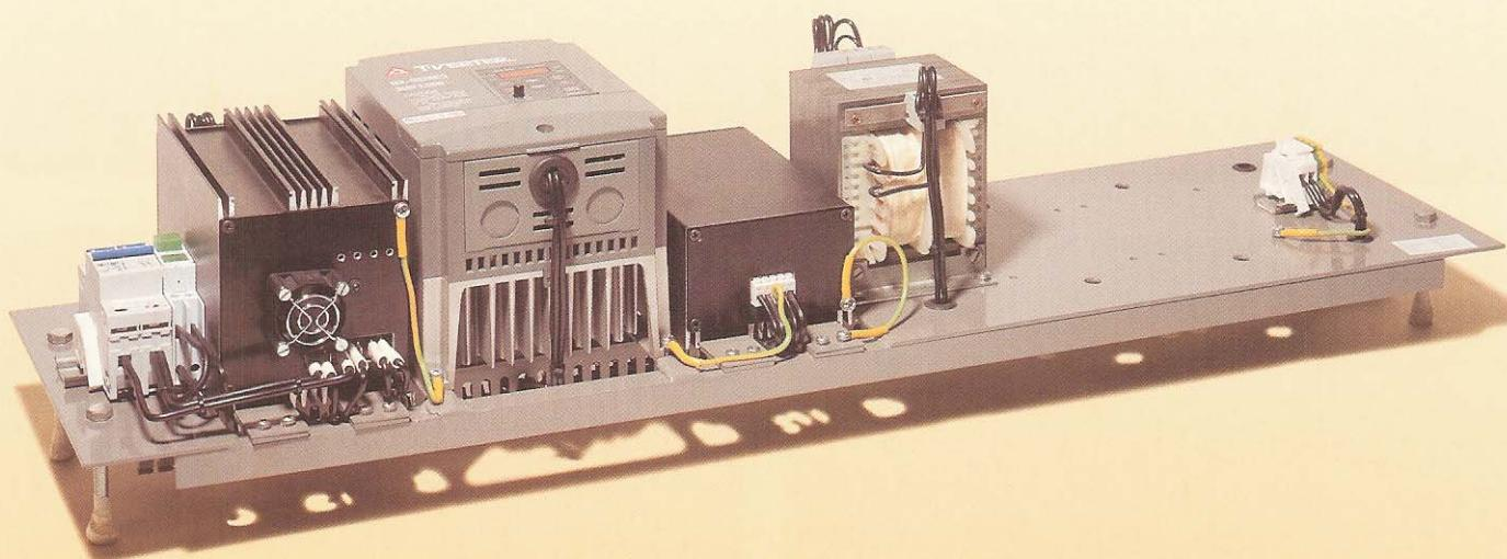
Elektronický měnič slouží k výrobě sinusového napětí 230 V, 50 Hz. Měnič je napájen ze stejnosměrného zdroje se jmenovitým napětím 24 V DC. Trvalý výstupní výkon je 250 VA. Účinnost je min. 80 %. Měnič je umístěn do rámu dvojitěho panelu universálního reléového stojanu.
