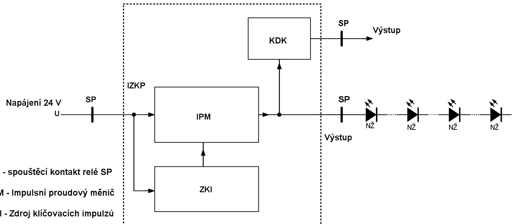
**Principiální blokové schéma pozitivní signalizace se svítivými diodami LED**
